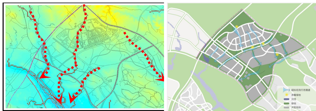
图 3.4 北区原始泄水路由和道路实施后泄水路由
