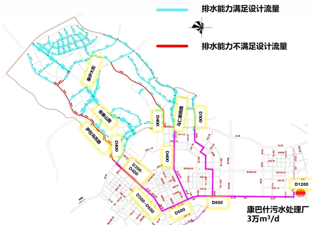
图 7.2 现状污水管网校核
