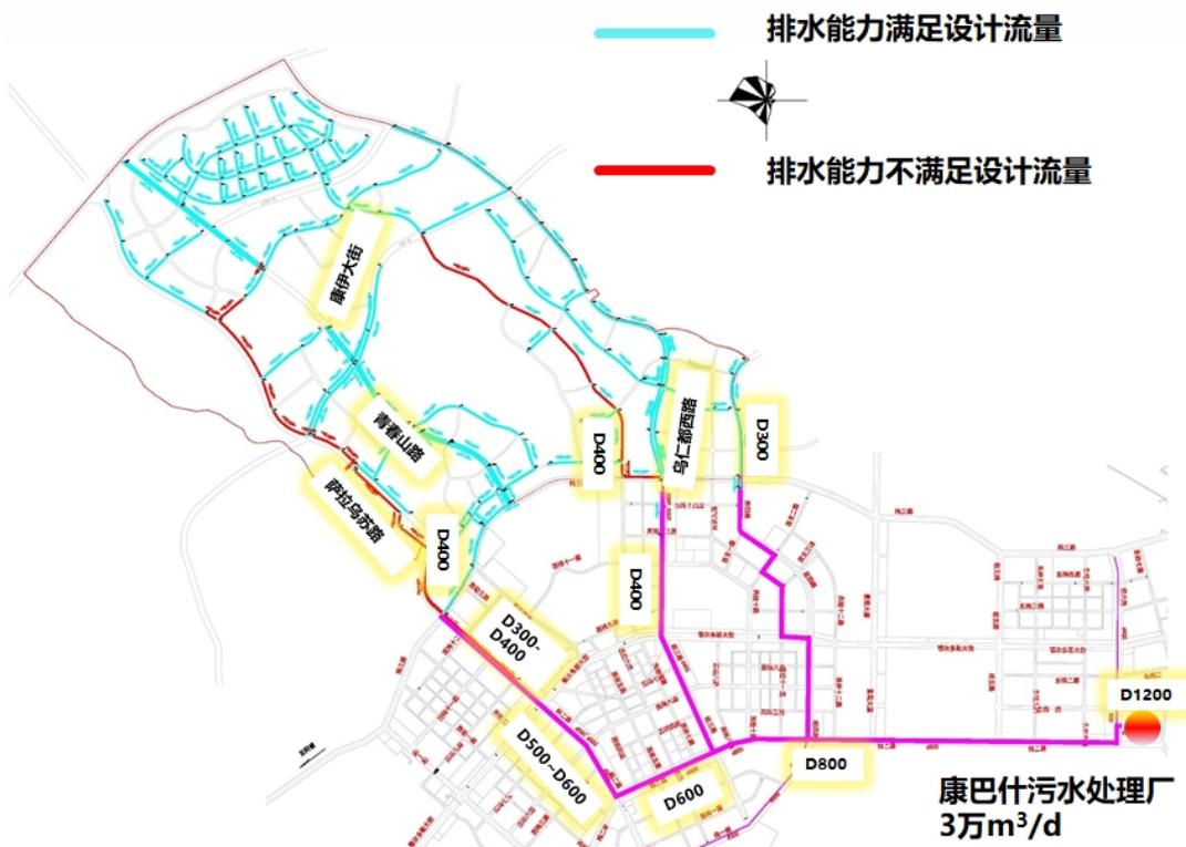
图 7.2 现状污水管网校核
